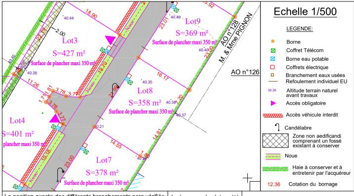
La position exacte des différents branchements sera vérifiée sur place avant la réalisation du projet de construction. L'adaptation de la construction au terrain sera étudiée en tenant compte du niveau et de la position de la voie nouvelle ainsi que des réseaux créés. Le bornage des lots a été effectué le 21/12/2022
